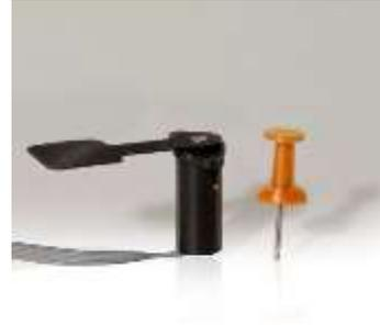
RS08 は直径 8mm のシャッタで、モータとすべての駆動電子機器が本体に内蔵されています。シャッタの可動範囲は 35°から 120°です。
